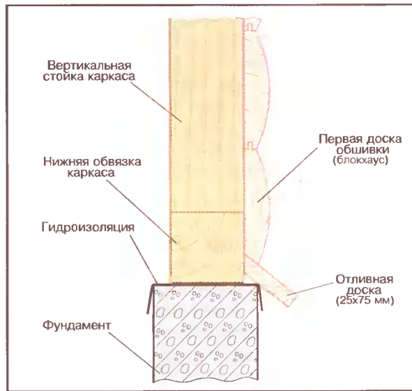
Рис. 5. Конструкция нижней части стены с отливной доской
