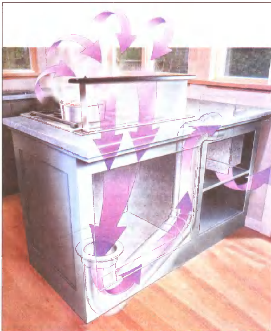
Рис. 1. Долой плохой воздух. Один из главных элементов системы с нижней вытяжкой — воздухозаборник, устанавливаемый за плитой или сбоку от нее. Другое важнейшее устройство системы — вытяжной вентилятор, смонтированный либо рядом с плитой, либо, как показано на рисунке, — в конце воздуховода.
