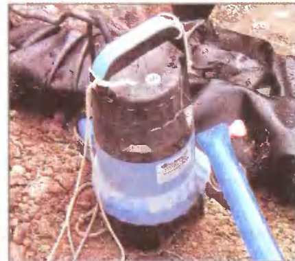
Источник круговорота воды — погружной насос
